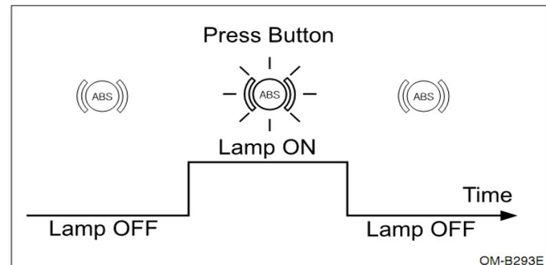
**Примечание:** на некоторых моделях автобусов кнопка самодиагностики ABS совмещена с кнопкой проверки контрольных ламп "Bulb Check".
